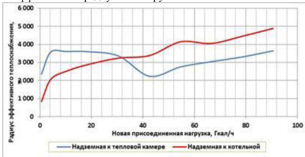
Рисунок 5.2 - Зависимость эффективного радиуса от присоединенной нагрузки
